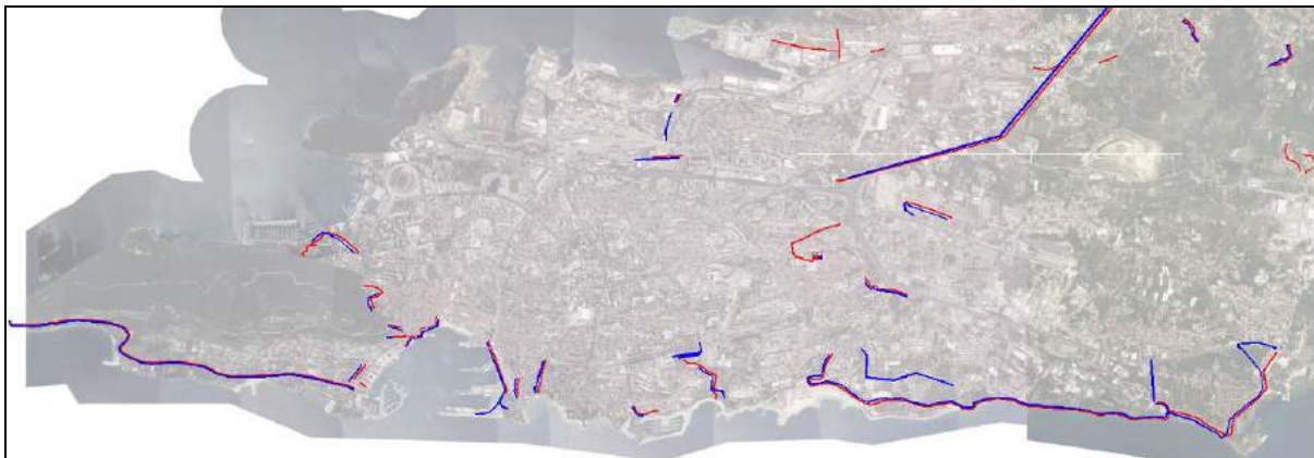
Grafički prikaz B-4: izgradnja/rekonstrukcija sustava vodoopskrbe grada Splita (plavo – uključeno u Rješenje MZOIP; crveno – konačno rješenje)
