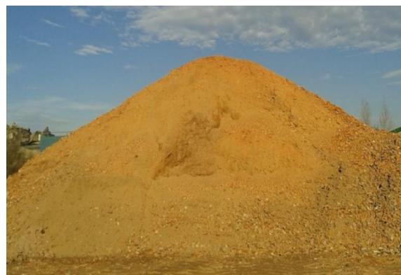
**Slika 4.** Kondicionirani beton i opeka
