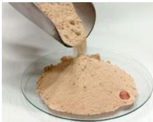
**Slika 6.** FGD gips nastao odsumporavanjem dimnih plinova
