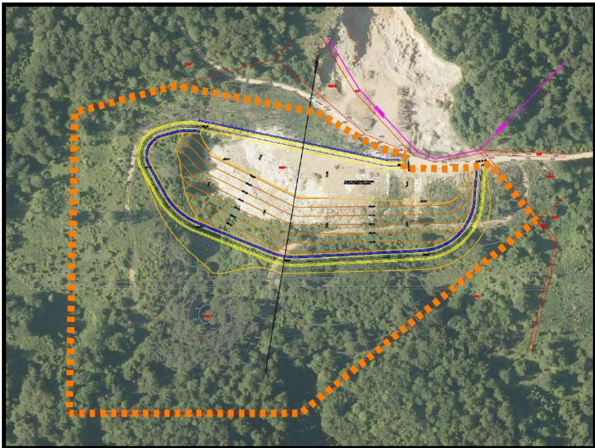
Slika 2.1-1. Planirana Situacija zatvorenog odlagališta otpada "JAVOROV VRH" s vidljivom granicom obuhvata (isprekidana narančasta linija), ulazima na odlagalište te saniranom i zatvorenom plohom otpada .
