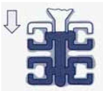
Slika 1.4.-8. Lijevanje taline u keramičku školjku
