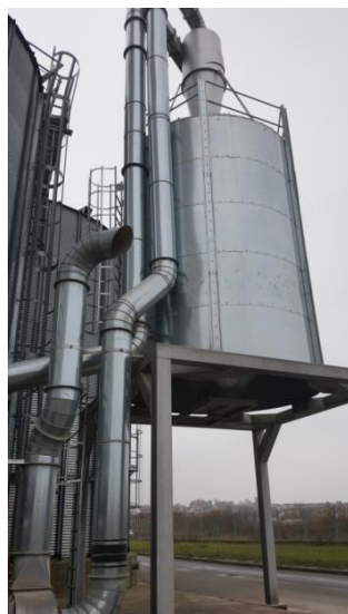
Slika 5.3. Prikaz vrećastog filtera (ciklona) za pročišćavanje zraka prije utovara
