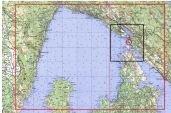
Slika 9. Domena numeričkog modela prognoze valova 41000 x 29000 m (Izvor: Građevinski fakultet u Rijeci; Maritimna studije plaže Oštro)
